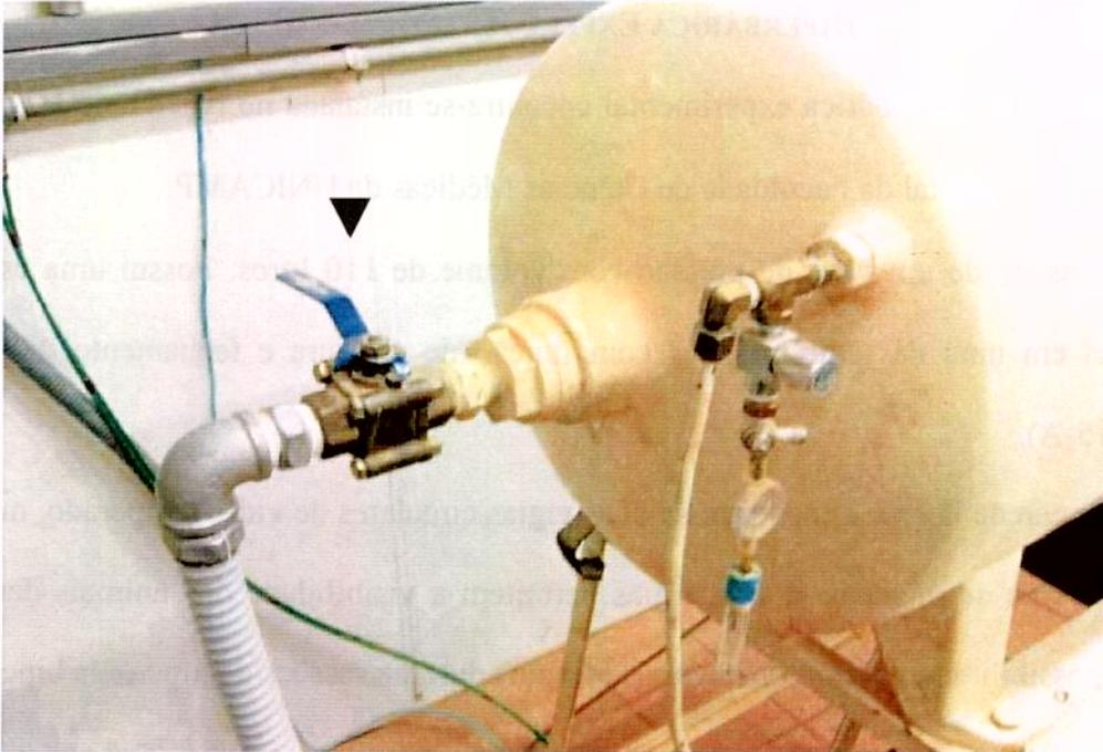
**Figura 15 C. Válvula principal para promover a exaustão de gases da câmara**
