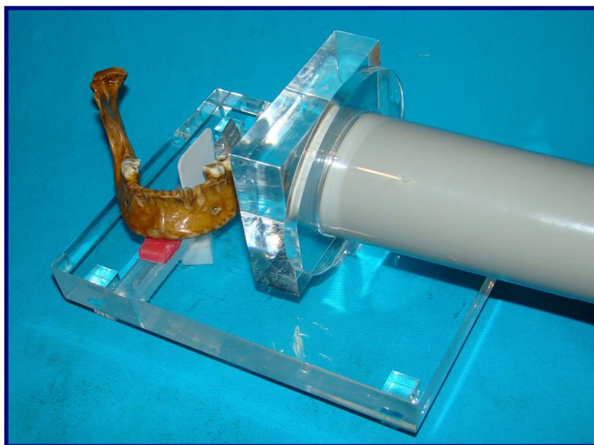
**Figura 1** - Suporte de acrílico para a padronização das exposições radiográficas
