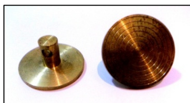
Figura 12. Eletrodos de 70% de cobre e 30% de zinco com 30mm de diâmetro.
