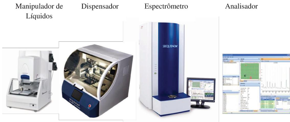
**Figura 7:** Equipamentos utilizados no Sistema MassArray.
