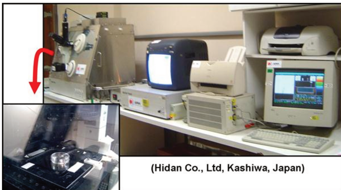
Figura 3. Fotografia do aparelho BioCell-Tracer®. O equipamento é constituído de um microscópio com base para as placas, uma câmara de vídeo, um televisor com aparelho de vídeo, um digitalizador de imagens e um microcomputador. No detalhe da foto, a imagem da placa que irá ser analisada dentro da câmara do equipamento.
