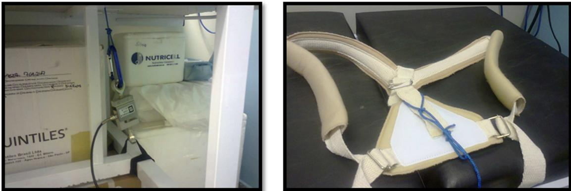
Figura 22 – Adaptação de célula de carga para avaliação da força muscular de tronco.
