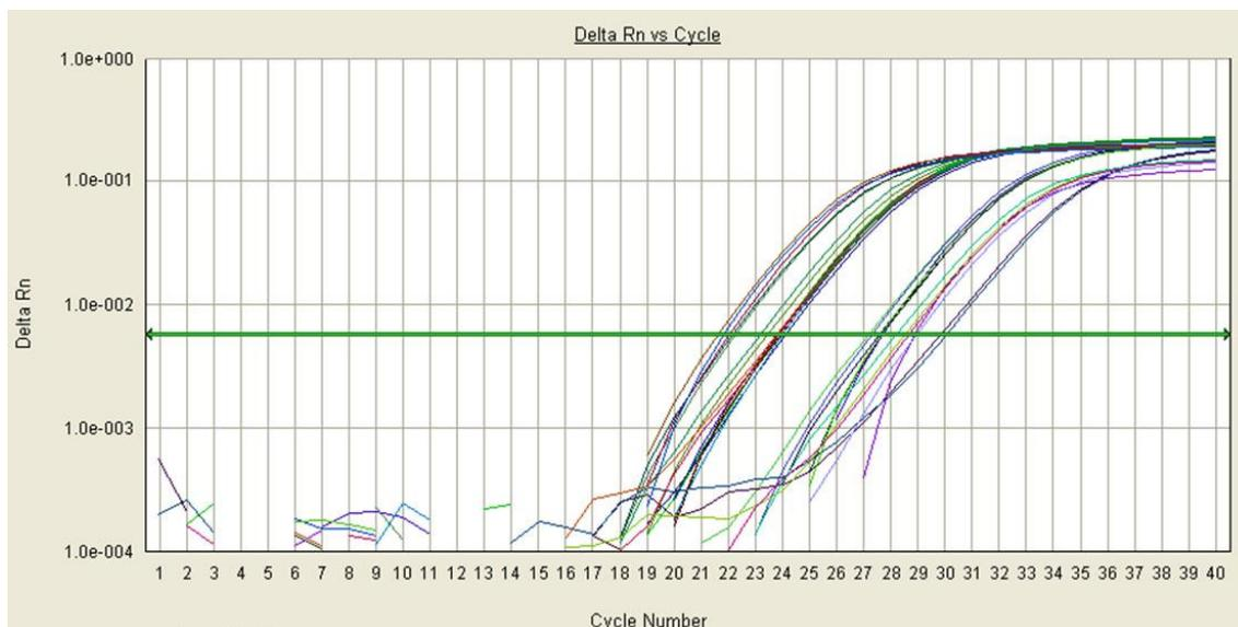
**Gráfico 1.** Resultado visual final de um ciclo completo de PCR em tempo real (*qRT-PCR*) para um determinado grupo de amostras. Notar a intensa diferença entre a amplitude das duas curvas sigmóides, revelando a grande diferença entre a expressão da amostra estudada (direita) e do controle interno (esquerda).
