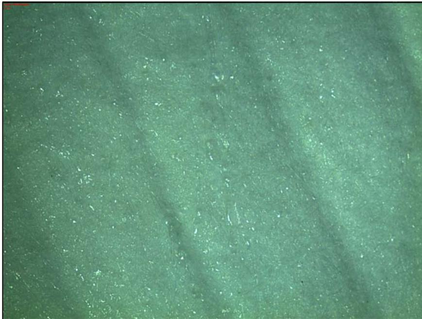
**Figura 10-** *Scaffold* de PLLA + HA - microscopia estereoscópica (aumento de 0,67x).
