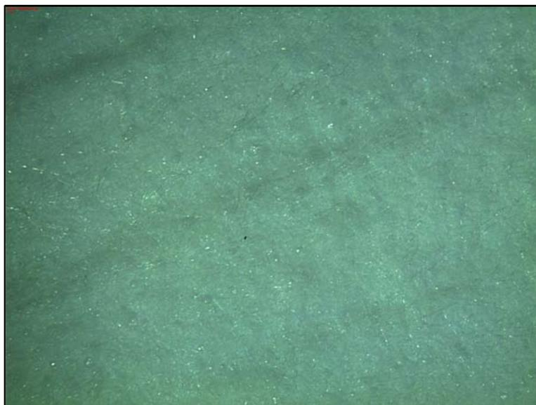
**Figura 7-** *Scaffold* de PLLA em microscopia estereoscópica (aumento de 0,67x).
