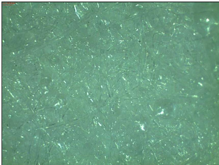
**Figura 11-** *Scaffold* de PLLA + HA - microscopia estereoscópica (aumento de 4x).
