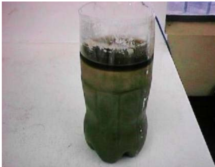
Figura 20 – Fases sobrenadante e precipitada correspondentes ao extrato líquido congelado à temperatura de -15^{\circ}\text{C}
