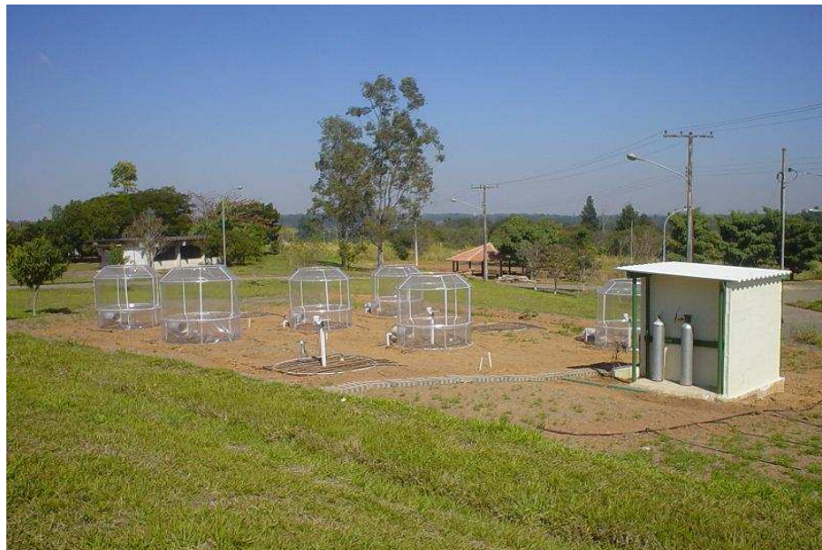
Figura 3.2: Disposição das estufas de topo aberto durante o experimento, cedida pela Embrapa
