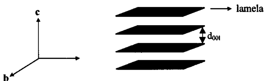
Figura 4.3- Ilustração da orientação das lamelas em relação aos eixos a, b e c.
