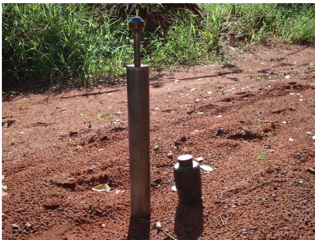
Figura 6 – Soquete padrão e cilindro de base cortante.
