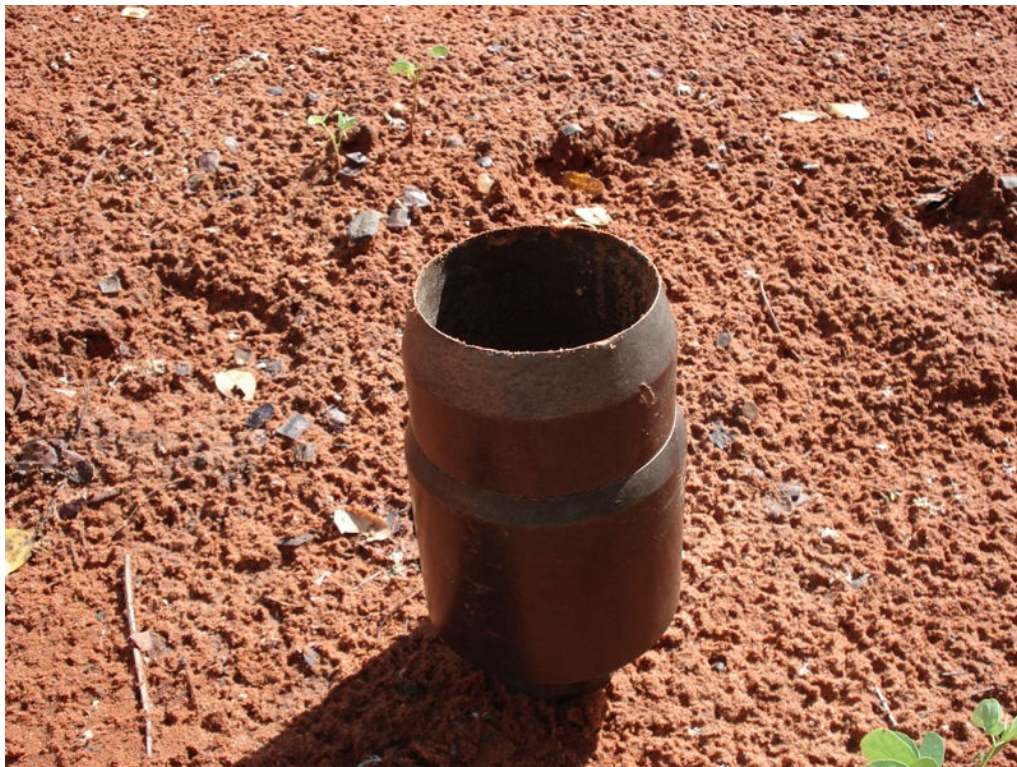
Figura 7 – Detalhe do cilindro de base cortante.
