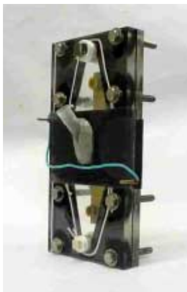
Figura 3.2: Reator 3, composto com um anodo de DDB.
