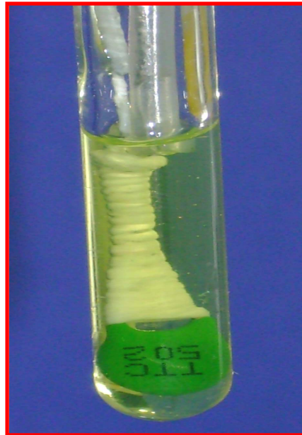
Figura 4 – Componente principal do sistema: termistor com encapsulamento em epóxi.
