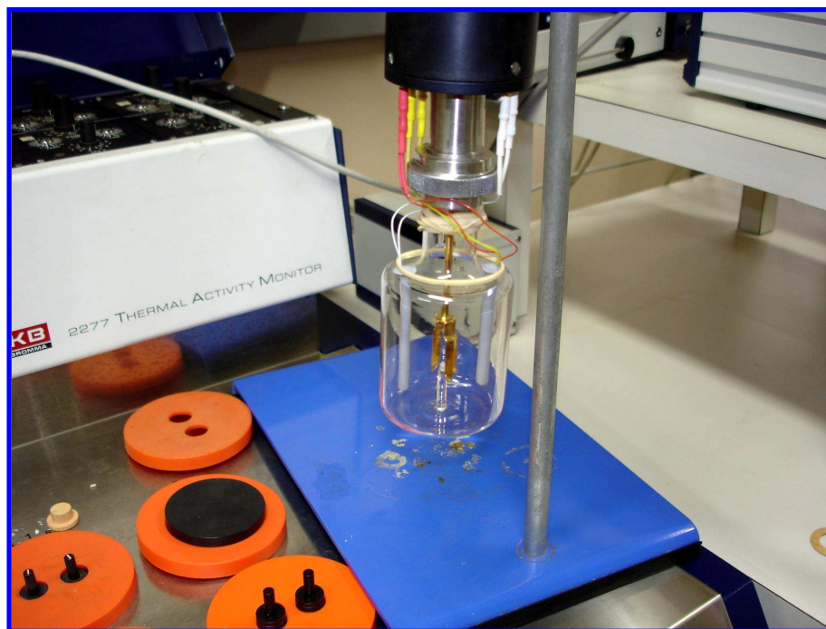
Figura 8 – Calorímetro de Pesquisa Solução-Reação: Thermometric, modelo 2225.
