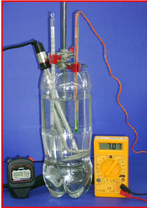
Figura 10 – Sistema com termômetro de divisão por °C e termistor
