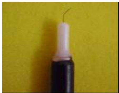
**B- Microeletrodo Beetrode®**
