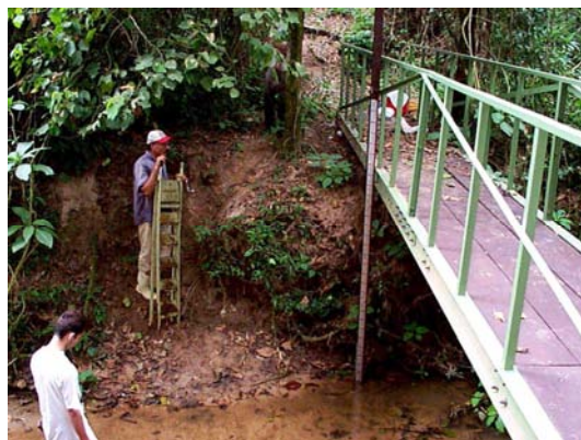
Figura 14 – Detalhe da medida da régua linimétrica na seção de controle da bacia.
