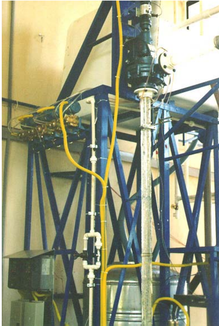
Figura IV-1- Vista geral da montagem do conjunto de BCS
