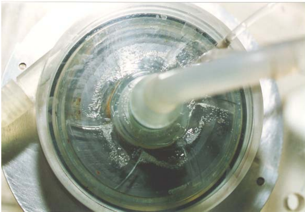
Figura IV-8 – Início da formação da bolha estacionária no canal do rotor
