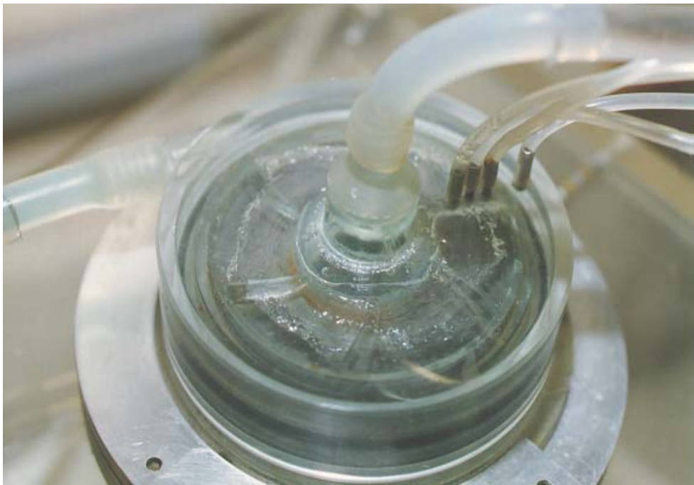
Figura IV-9 – Evolução do tamanho da bolha estacionária no canal do rotor
