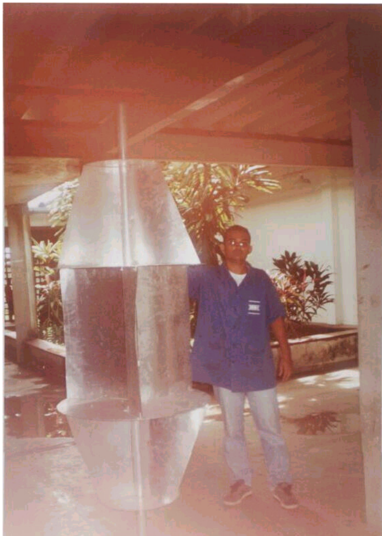
Figura 1.1 – Rotor Savonius Implementação UFMA
