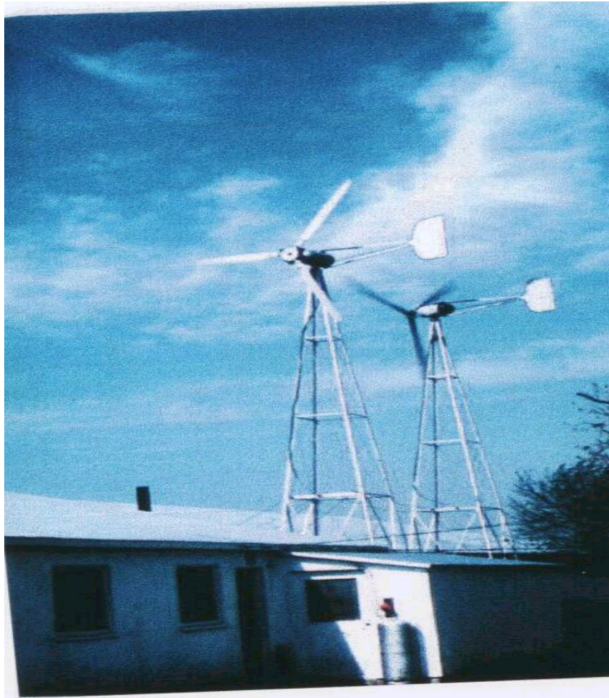
Figura 2.22 – Aero geradores de eixo horizontal para geração de eletricidade acoplado diretamente com a carga.
