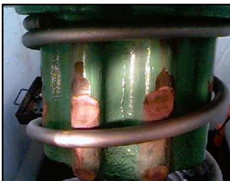
Figura 3.3: Desgaste na mola da válvula
