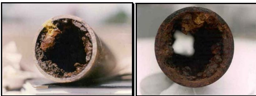
Figura 4.38: Interior da testemunha antes e depois da aplicação do ortopolifosfato
