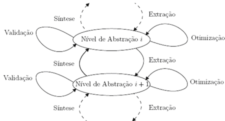
Figura 2.8: Modelo de representação do processo de projeto de sistemas digitais proposto por Suzim
