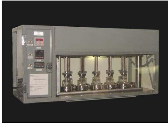
**Figura 11.** Máquina de ciclagem mecânica ER-FOP 10.
