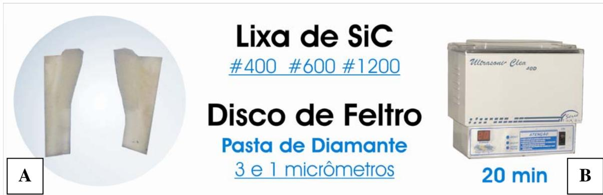
**Figura 14.** A – Esquema ilustrativo dos espécimes incluídos aos pares em resina de poliestireno para ensaio de microdureza Knoop; seqüência de acabamento e polimento; B - Cuba de ultra-som.
