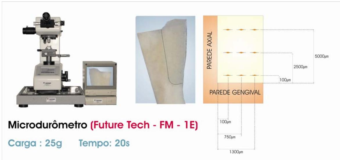
**Figura 15.** Aparelho para realização do teste de microdureza Knoop e esquema representativo das localizações das endentações em cada corpo de prova.
