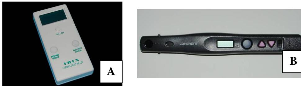
**Figura 9.** A – Radiômetro Hilux; B – Medidor de potência Laser Check.
