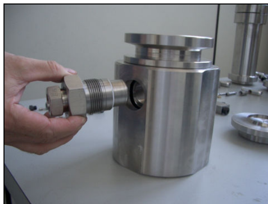
Figura 3.8 – Fixação e vedação da unidade de precipitação pelo encaixe das janelas de quartzo e do sensor de pH.
