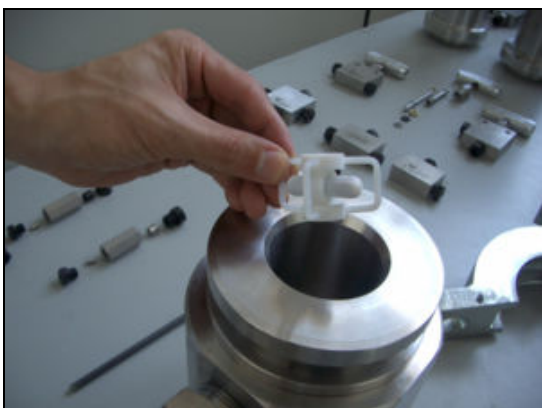
Figura 3.9 – Barra de agitação magnética apoiada em uma estrutura de teflon.
