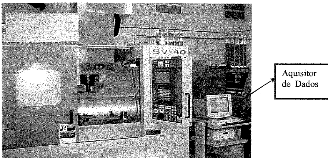
Figura 10 - Centro de Usinagem Vertical, modelo SV-40 MORI SEIKI com comando eletrônico FANUC.
