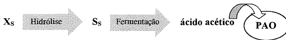
Figura 5.5. Caminho geral de reação para consumo das fontes de carbono pelos microorganismos acumuladores de fosfato (PAO).
