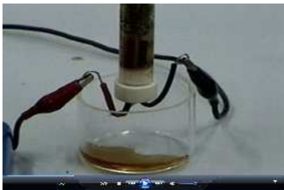
Figura 61: Tomada do filme mostrando a coloração da solução de iodeto, já eletrolisada, deixando o interior da bureta.
