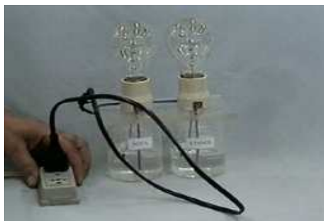
Figura 15 : Teste de condutividade da água pura e etanol.
