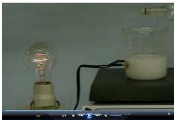
Figura 45: Luminosidade da lâmpada próxima ao ponto final da titulação.
