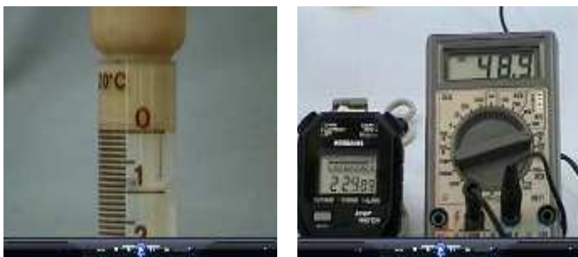
Figura 58: Detalhe da tomada de volume de hidrogênio, tempo e corrente elétrica durante o experimento.
