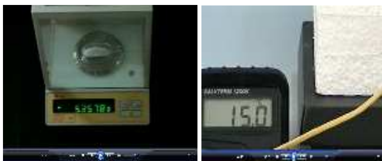
Figura 70: Leitura da pesagem do \text{NH}_4\text{Cl} e temperatura final da solução no calorímetro após dissolução do sal.
