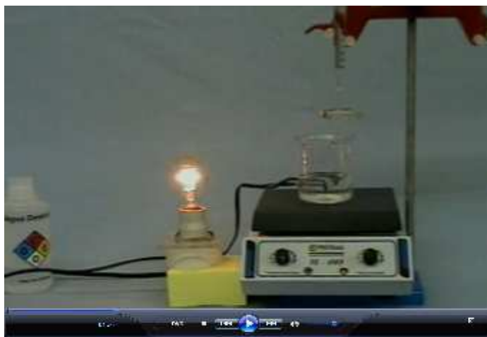
Figura 41 : Aparato usado para titulação da solução de ácido sulfúrico.
