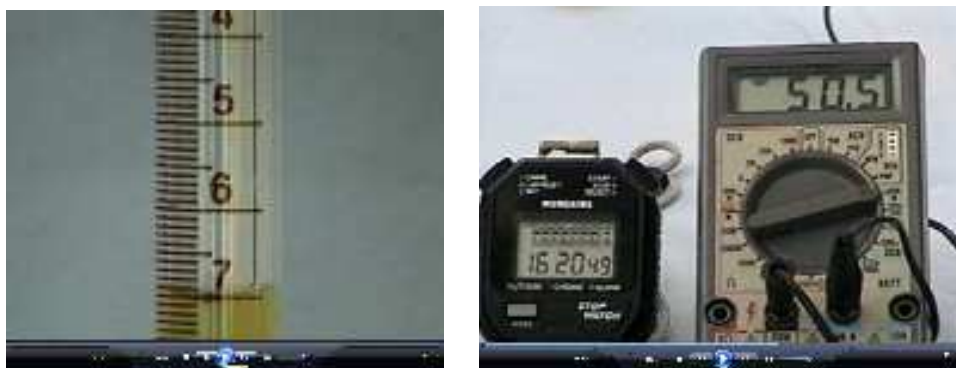
Figura 59: Tomada de tempo, corrente elétrica e volume gasoso ao final da eletrólise.
