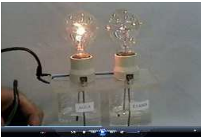
Figura 18 : Teste de condutividade das soluções de iodeto de sódio em água e etanol
