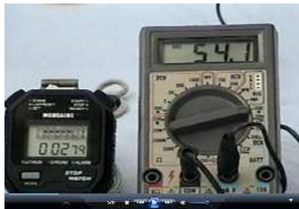
Figura 57: Cronômetro e multímetro usados na eletrólise.
