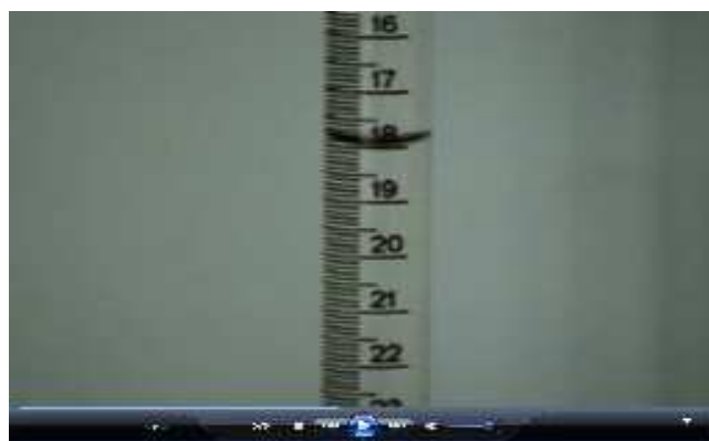
Figura 47: Volume gasto de solução de \text{Ba}(\text{OH})_2 na bureta no ponto final da titulação.
