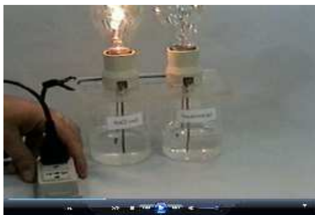
Figura 14: Teste de condutividade das soluções de NaCl e Sacarose.
