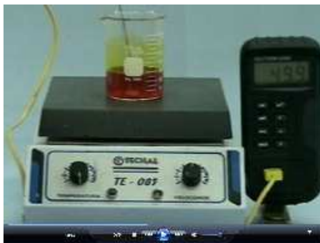
Figura 23: Aquecimento da solução de dicromato de potássio para solubilização a 50 °C.
