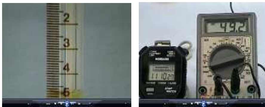
Figura 60: Exemplo de dados, volume de H_2 , tempo e corrente, que podem ser observados no filme para se determinar a carga do elétron.
