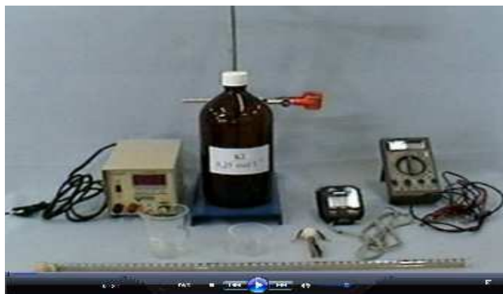
Figura 05 : Experimento número 05 sobre ELETRÓLISE.
