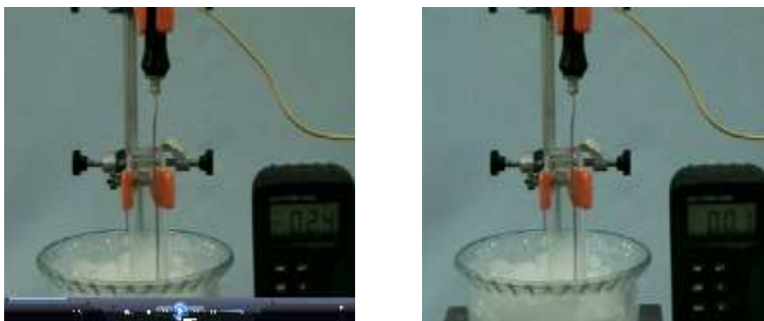
Figura 32: Superfusão da água pura (à esquerda) e de congelamento da água pura (à direita).
