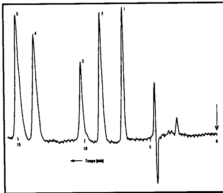
Figura V.12: Cromatograma mostrando peralogenados e clorofórmio. FM: MeOH:H 2 O 80:20 v/v, vazão 0,6 mL/min, detecção em 220 nm. 1- CHCl 3 ; 2- CBr 4 ; 3- CCl 4 ; 4- C 2 Br 4 e 5- C 2 Cl 4 .
