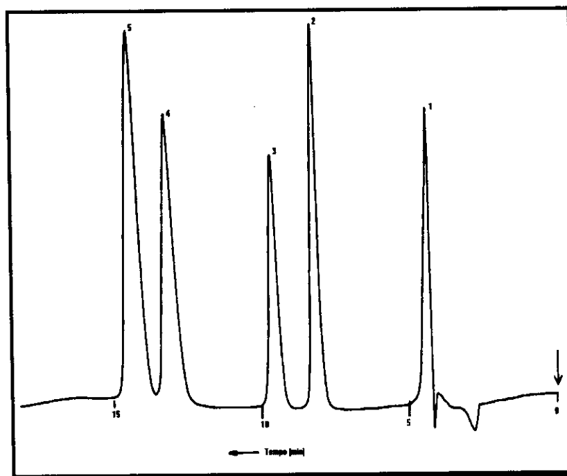
Figura V.13: Cromatograma mostrando peralogenados e bromofórmio. FM MeOH:H 2 O 80:20 v/v, vazão 0,6 mL/min, detecção em 220 nm. 1- CHBr 3 ; 2- CBr 4 ; 3- CCl 4 ; 4- C 2 Br 4 e 5- C 2 Cl 4 .
