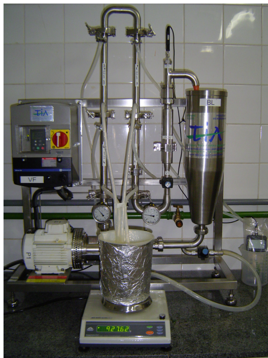
Figura 12 – Equipamento micro-piloto utilizado nos ensaios de microfiltração.
