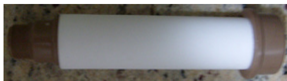
Figura 3.11: Difusor de bolhas instalado no interior da coluna de borbulhamento.
