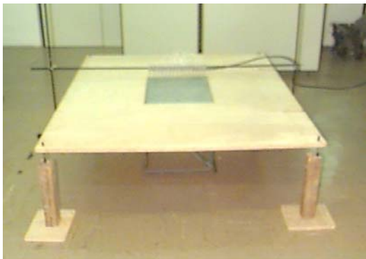
Figura 6.5 Arranjo experimental da medição de FRFs em campo próximo.
