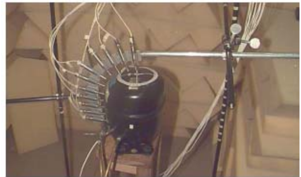
Figura 6.20: Arranjo experimental composto por 10 microfones e um acelerômetro.
