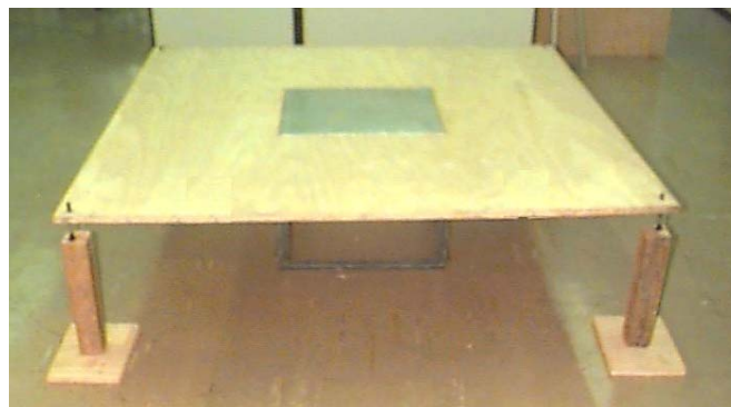
Figura 6.3: Arranjo experimental de uma placa montada em um anteparo.
