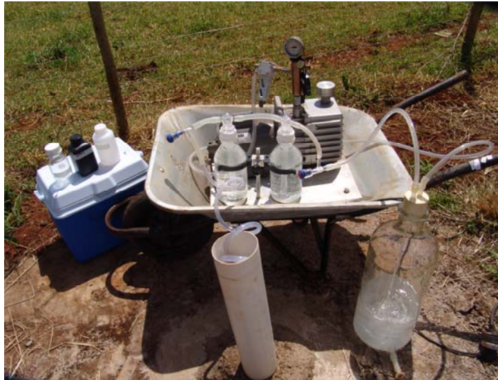
Figura 4.6-1 – Conjunto utilizado para amostragens nos poços de monitoramento.
