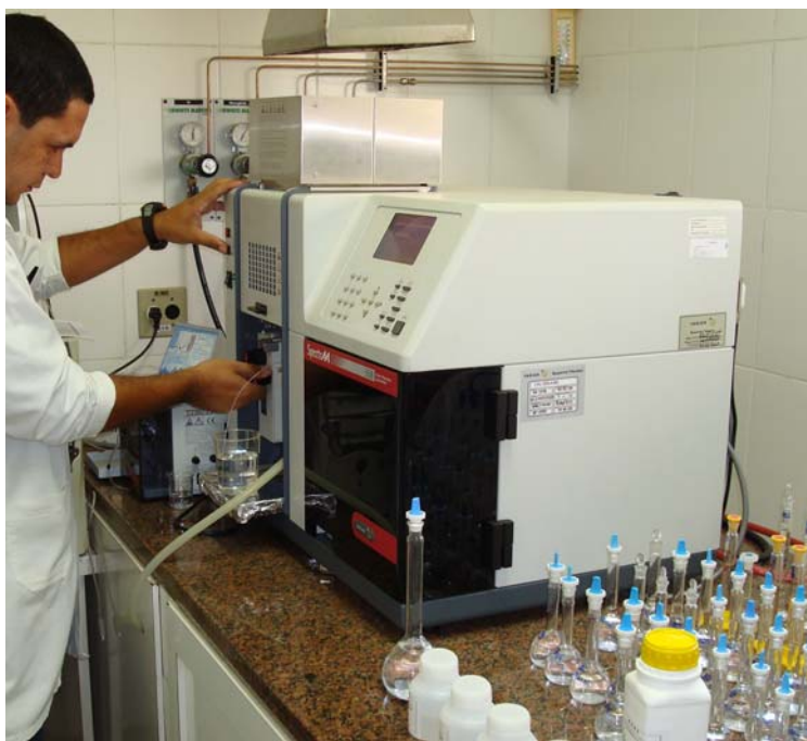
Figura 4.7-1 – Espectrofotômetro de Absorção Atômica da SABESP utilizado para análises de metais nas amostras de água subterrâneas e solo.
