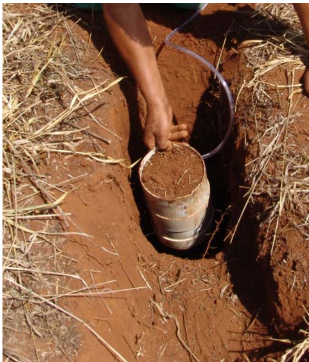
Figura 4.6-4 – Detalhe da colocação dos coletores de amostras de água de drenagem no campo experimental da Fazenda Marfim, Restinga-SP.
