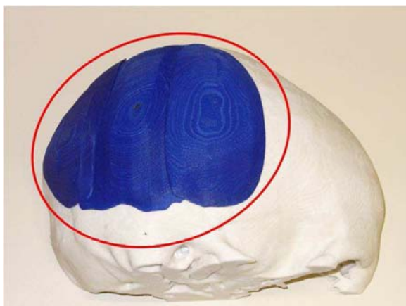
Placas em ABS/FDM utilizadas para produzir molde de gesso
