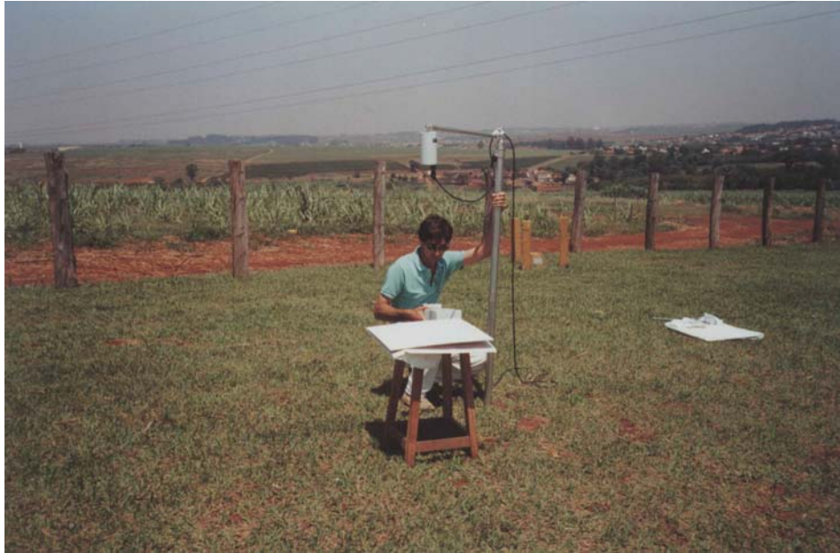
Figura 7: Radiômetro Cimel Electronique modelo CE 313-22
