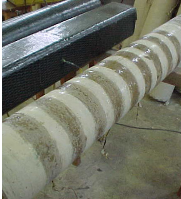
Figura 4.31- Resina primária em processo de secagem
