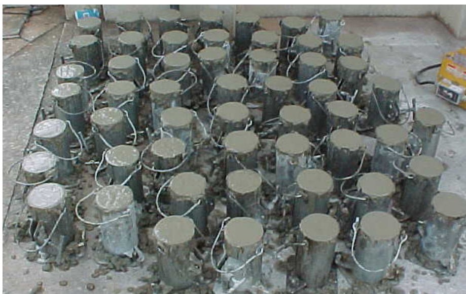
Figura 4.26- Corpos de prova moldados para análise
