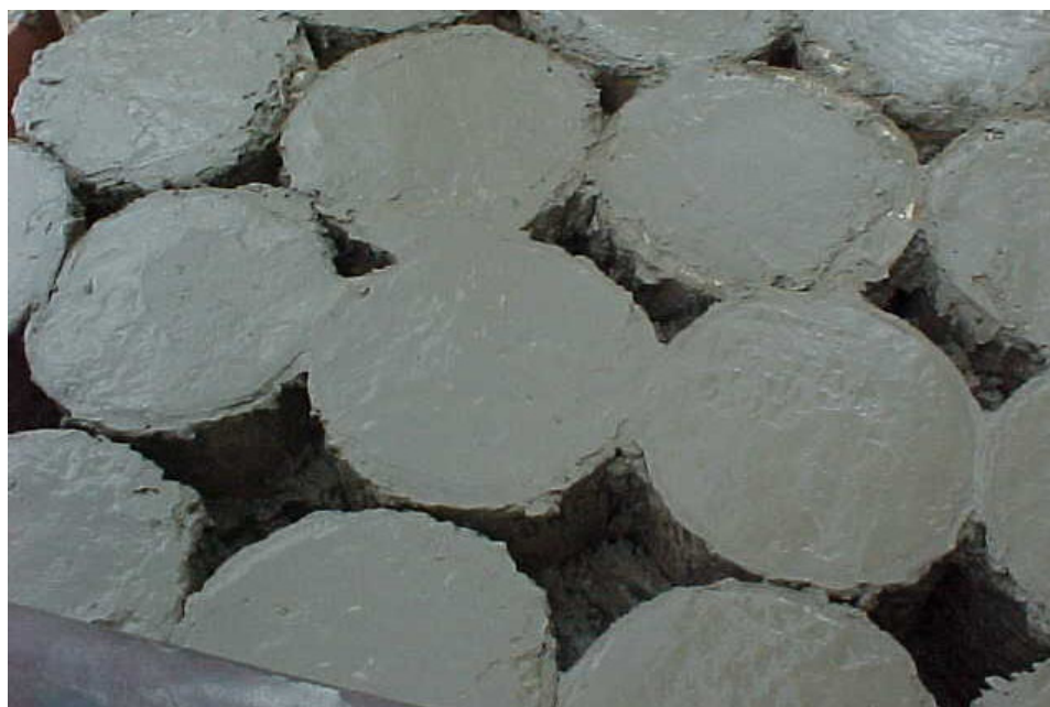
Figura 4.25- Detalhe dos pilares após concretagem
