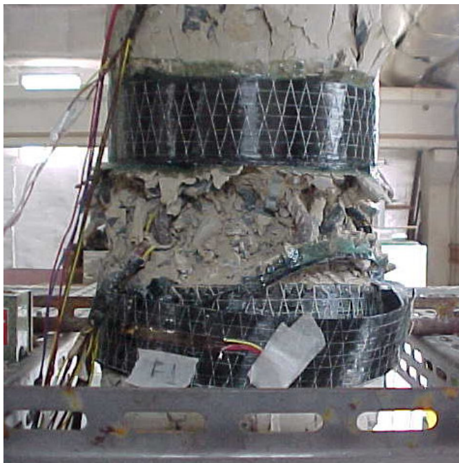
Figura 5.14 - Detalhe da ruptura na região entre laços
