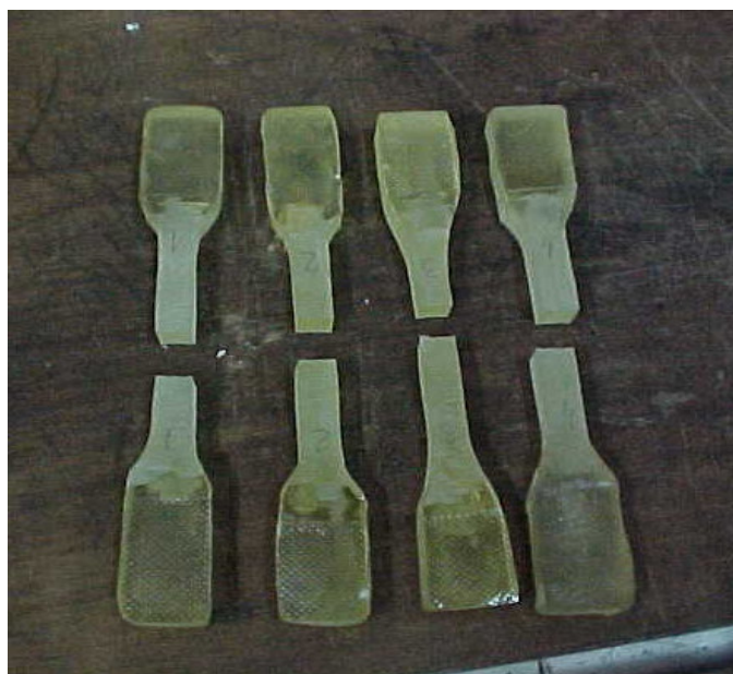
Figura 4.5 - Amostras da resina Primária após o ensaio
