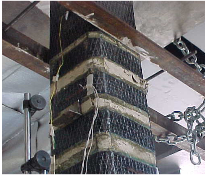
Figura 5.24 - Ruptura na região entre laços
