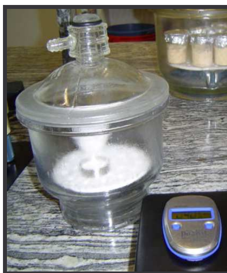
FIGURA 4.2. Ilustração do dessecador com água destilada (100% de umidade) para determinação da isoterma de adsorção através do medidor portátil pa_w kit.
