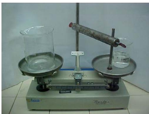
Figura 8: Montagem utilizada para determinação da resistência relativa de partículas de hidrogéis.
