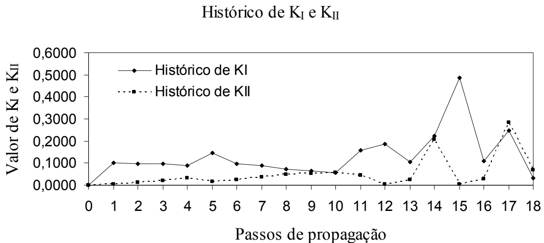
Figura 9.4 – Históricos de K_I e K_{II} para elemento de propagação de comprimento l = 0,002 (Alongamento 1 \times 10^{-5} ).
