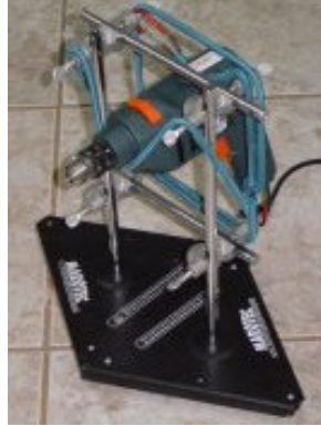
Figura 24.- Dispositivo de posicionamento da furadeira para ensaios na Sala de Ensaio Acústico da Unicamp.
