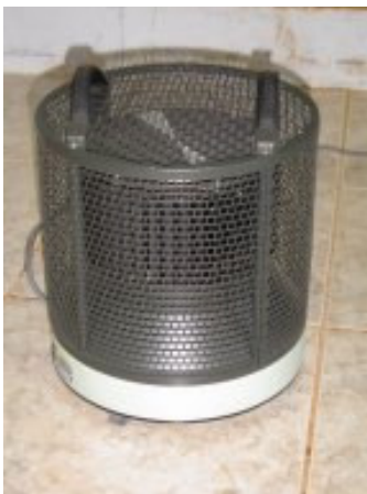
Figura 27– Fonte de ruído de referência B&K 4204 utilizada nos ensaios pela metodologia por comparação da ISO 3743/1 (1994).
