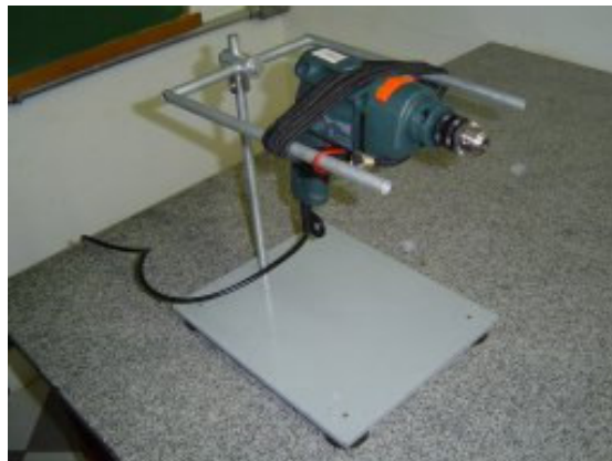
Figura 31 – Suporte para realização de ensaio de medição do nível de pressão sonora da furadeira em operação.
