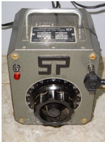
Figura 23 – Transformador variador de tensão utilizado para estabilizar a tensão de alimentação da furadeira.
