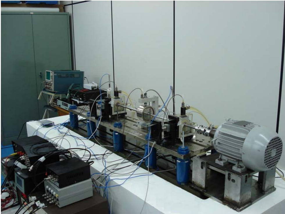
Figura 5.3 - Montagem completa da bancada experimental com dois mancais hidrodinâmicos e uma massa inercial no centro.
