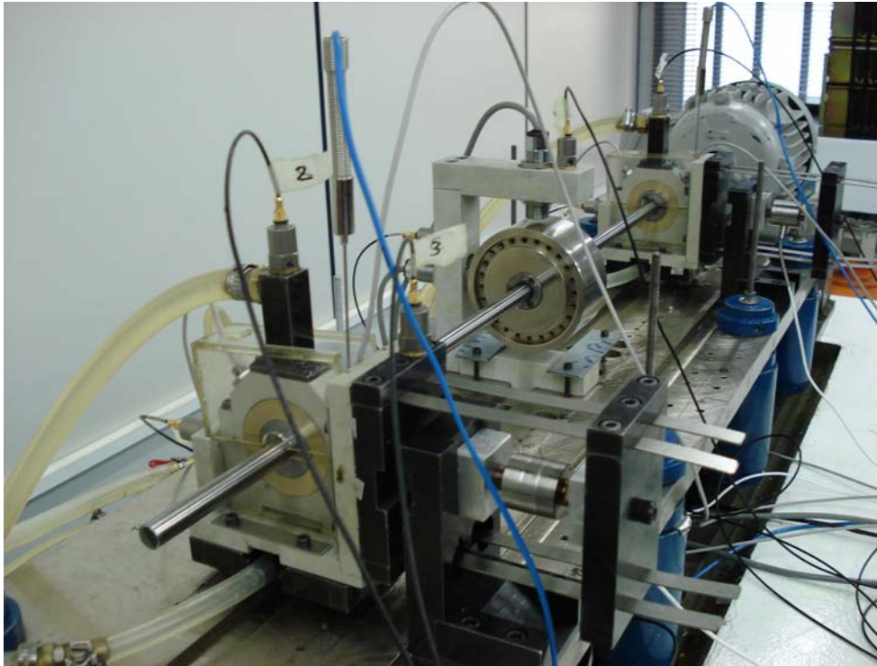
Figura 5.5 – Mancal hidrodinâmico montado na bancada experimental
