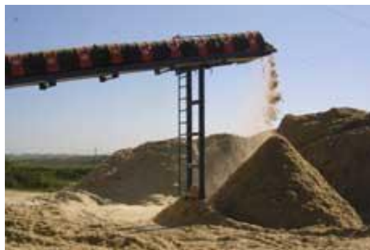
Figura 15 – Resíduo da Fibra do Bagaço da Cana-de-açúcar gerados nas usinas de álcool e utilizada apenas até hoje para geração de energia nas termoeletricas [10].
