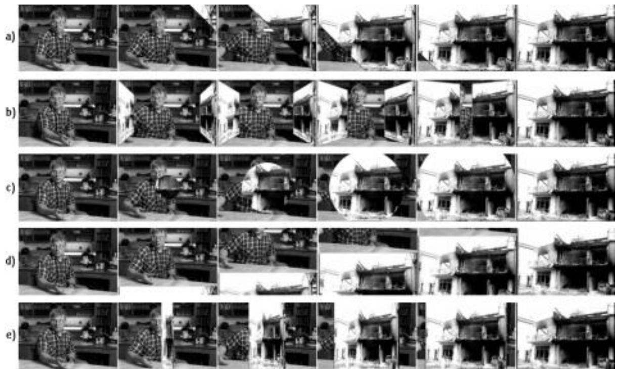
Figura 1.6: Exemplos de alguns padrões de wipes em um segmento de vídeo digital: a) diagonal , b) door open , c) iris round , d) push vertical e e) split .
