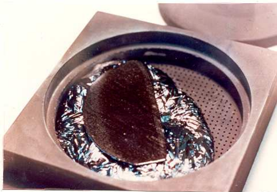
Fig-9: Disposição dos substratos de GaAs-poli junto à solução de Ga-Sn, dentro do box.
