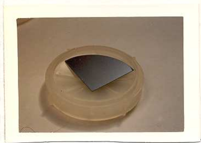
Fig-10: "Wafer" dentro do recipiente adequado para guarda-lo.
