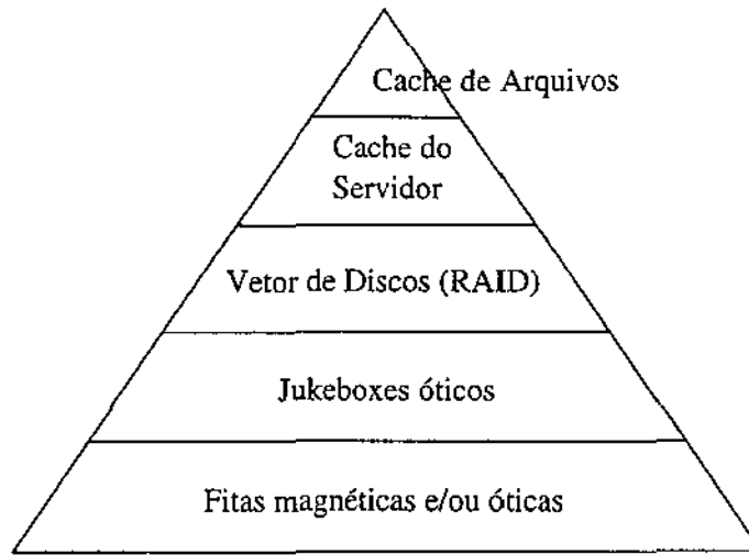
Figura 2.3: Esquema de gerenciamento de memória de uma arquitetura de vídeo sob demanda.
