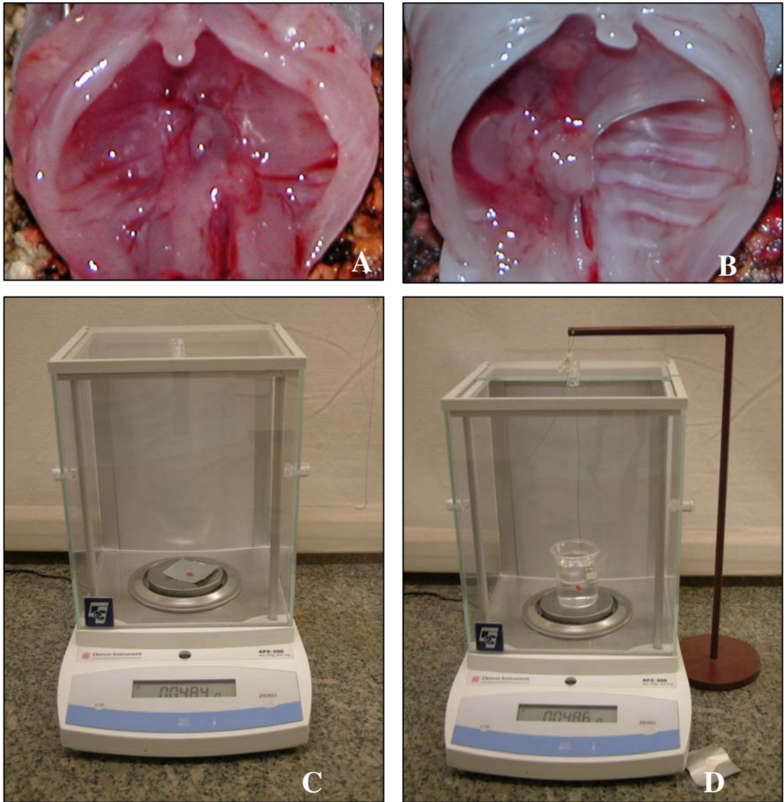
Figura 4- Fotografias de fetos dissecados sem HDC em A e com HDC em B, mensuração do peso pulmonar em C e mensuração do volume pulmonar em D.
