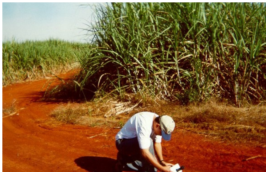
Figura 7. Obtenção da radiação direta com o radiômetro solar CIMEL-317, durante o período da passagem do satélite.
