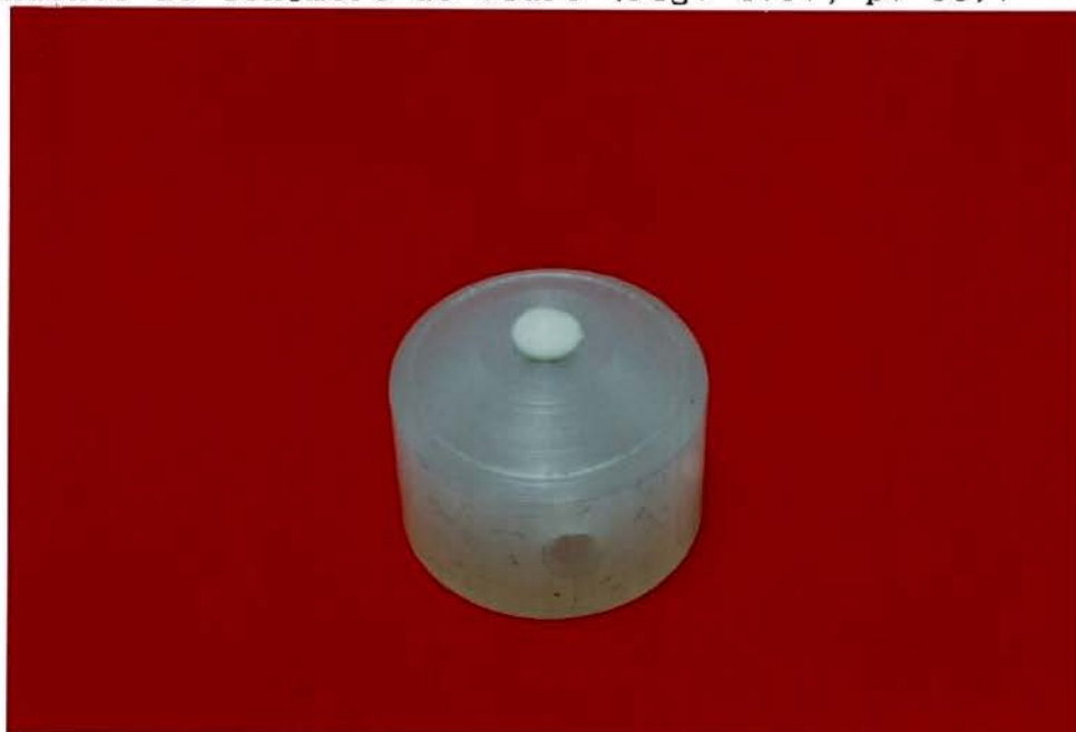
Fig. 4.9 Fotografia da matriz de teflon com a amostra do Cimento de Ionômero de Vidro.
