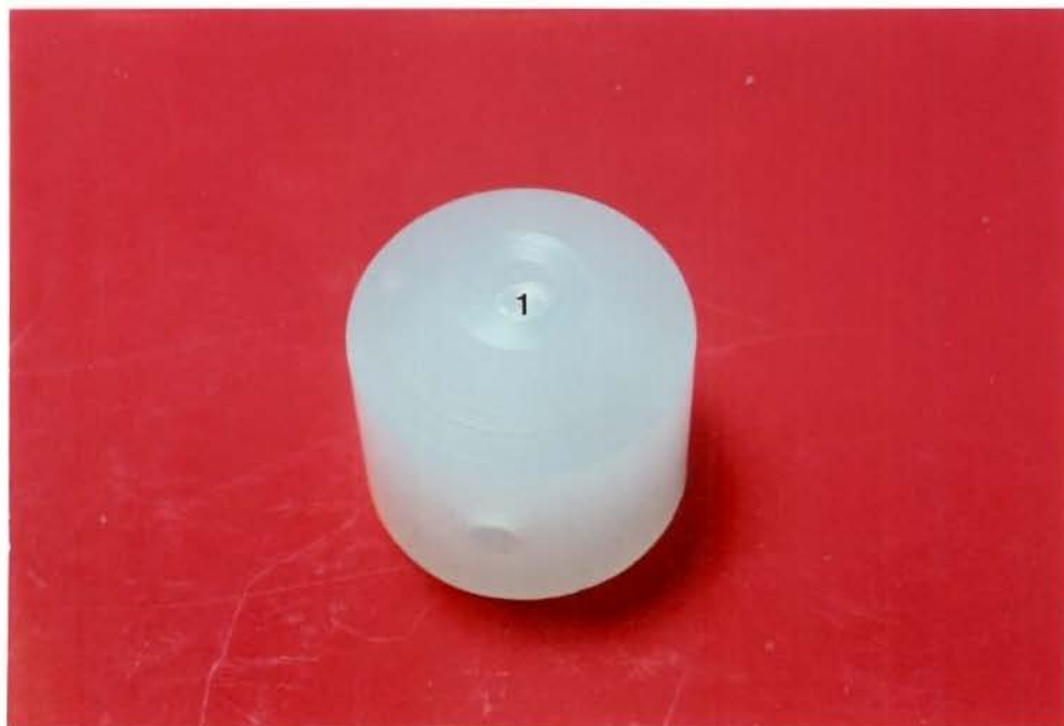
Fig. 4.1. FOTOGRAFIA DA MATRIZ DE TEFLON PARA A CONFECÇÃO DAS AMOSTRAS DE CIMENTO DE IONÔMERO DE VIDRO 1- Cavidade para a inserção do cimento
