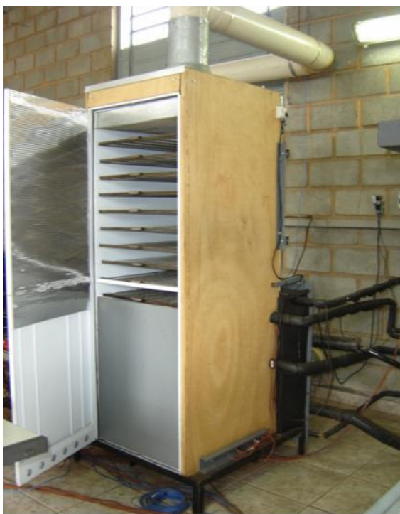
Figura 6.11: Secador de bandeja com capacidade para 50 kg de produto.
