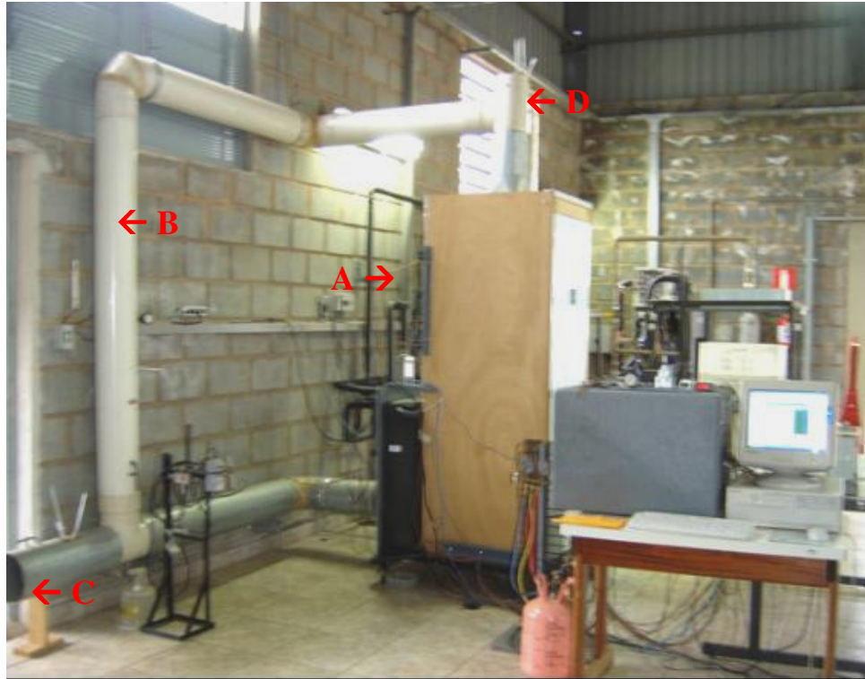
Figura 6.13: Secador com sistema de recirculação do ar de secagem. A = secador; B = recirculação do ar; C = entrada ar ambiente; D saída do ar quente.
