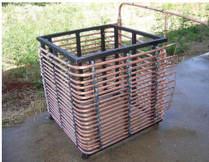
Figura 5.5: Evaporador de serpentina (primeiro circuito) para o sistema de resfriamento de água gelada.
