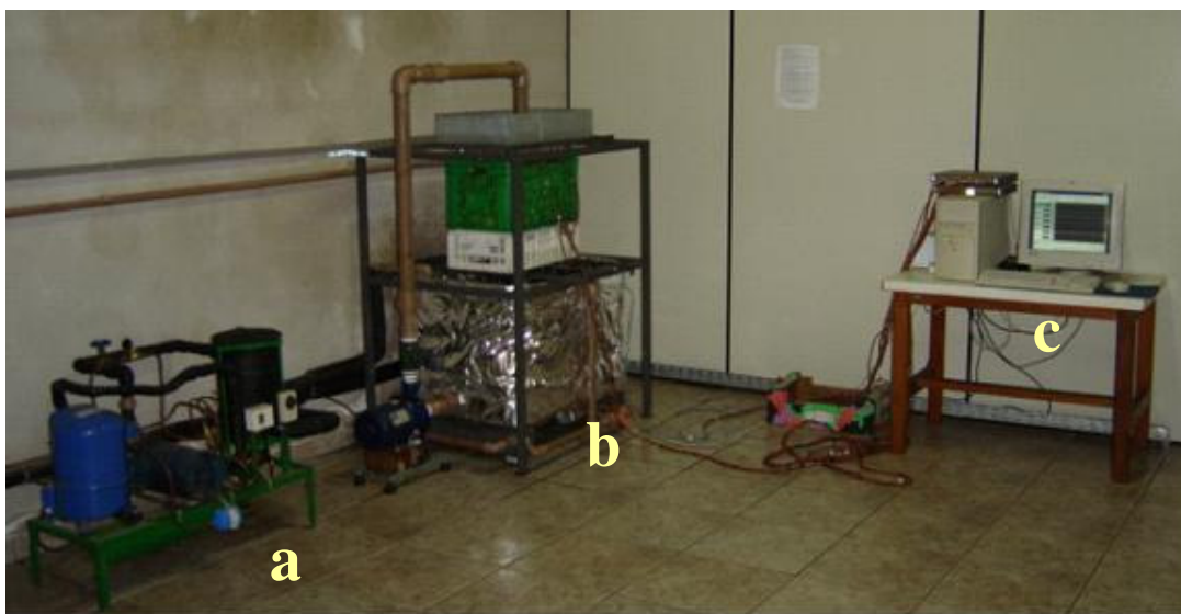
Figura 4.1: Sistema de resfriamento por aspersão utilizado durante os experimentos incluindo o sistema de refrigeração mecânica (a), o sistema de aspersão da água gelada (b), e o sistema de aquisição dos dados (c).
