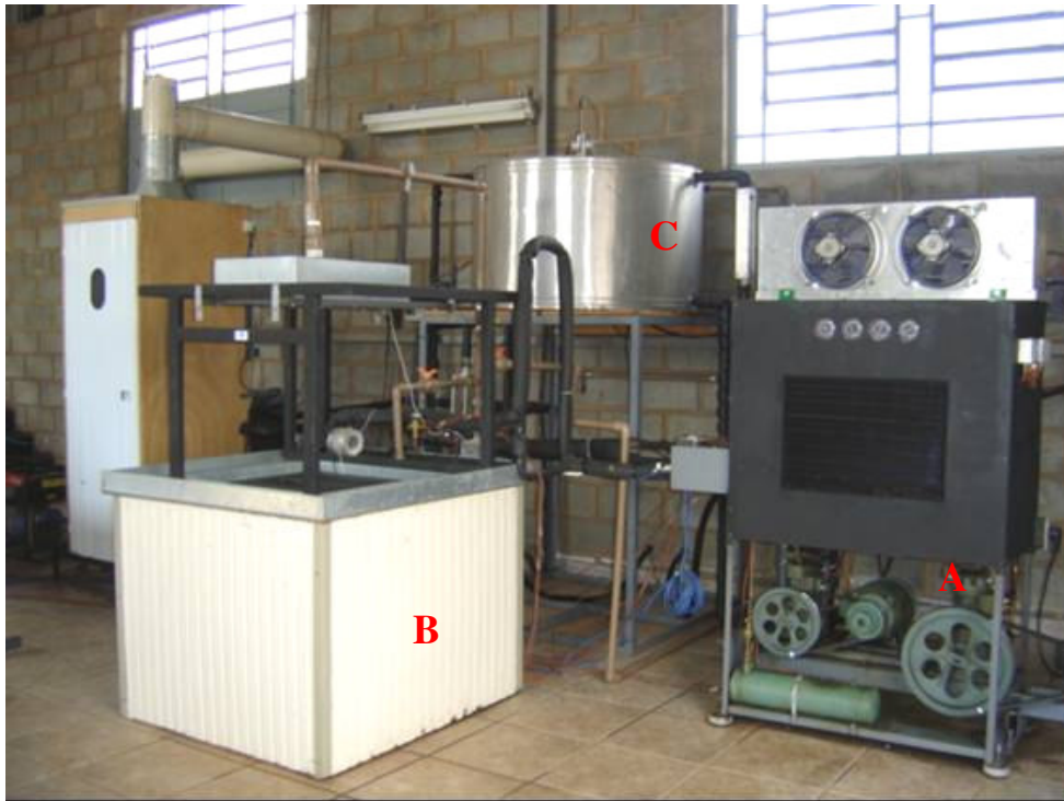
Figura 5.8: Sistema de bomba de calor água/água em casca construído para resfriamento e secagem de tomates. Onde: A = compressores; B = reservatório de água gelada; C = reservatório de água quente.
