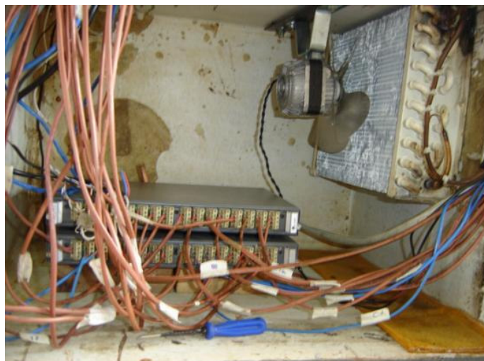
Figura 5.12: Placas A/D CAD 12/32-32 da marca Lynx com 16 canais cada placa.
