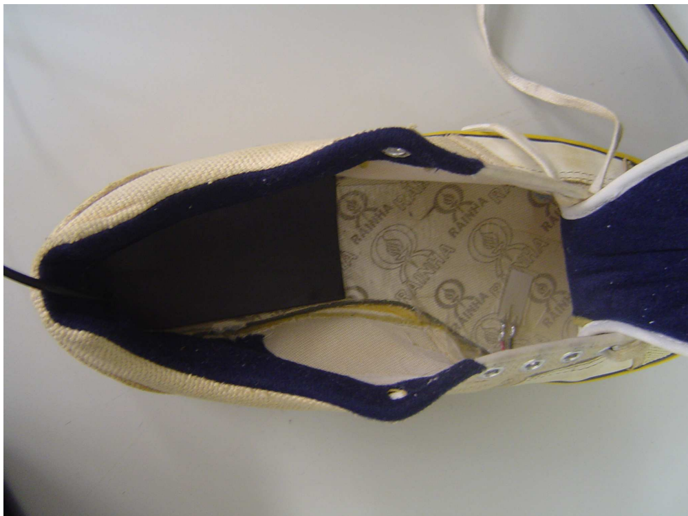
Figura 105 – Detalhe da disposição dos sensores dentro do tênis.
