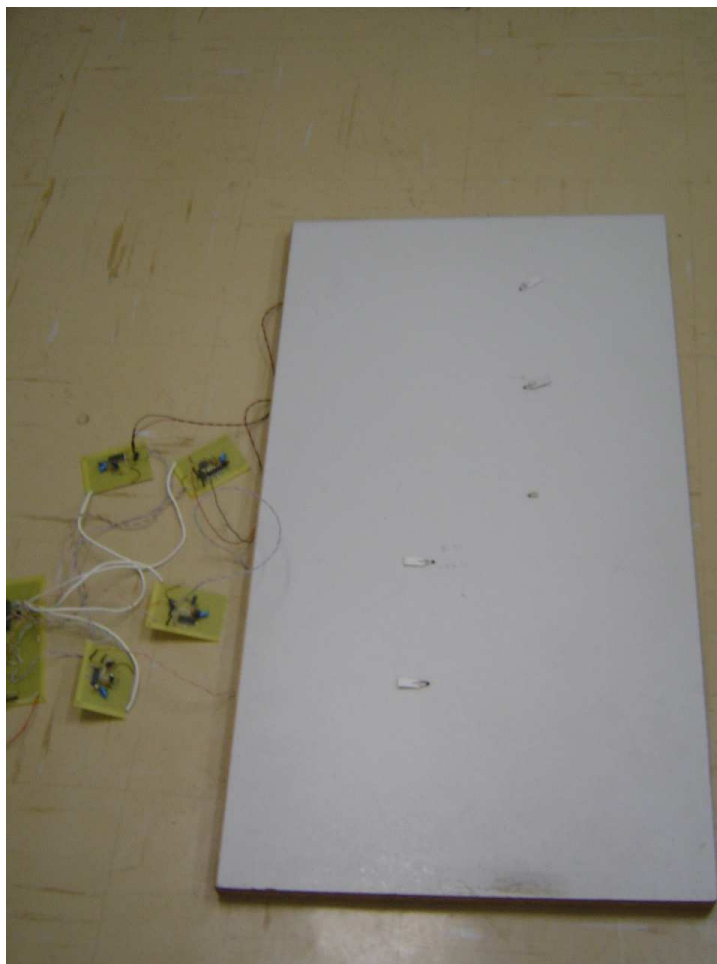
Figura 42 – Foto da plataforma com sensores e circuito.
