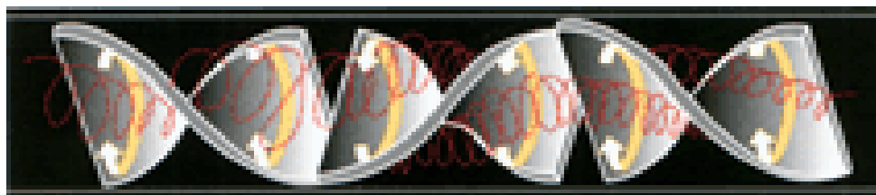
Figura 2.12 – Desenho esquemático de geração de turbulência. Fonte: Chemineer (2006).
