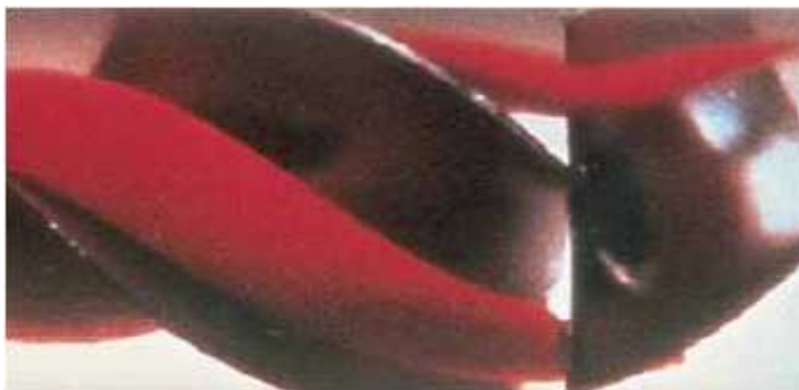
Figura 2.11 – Estiramento das camadas – mecanismo de mistura para o regime laminar. Fonte: Chemineer (2006).
