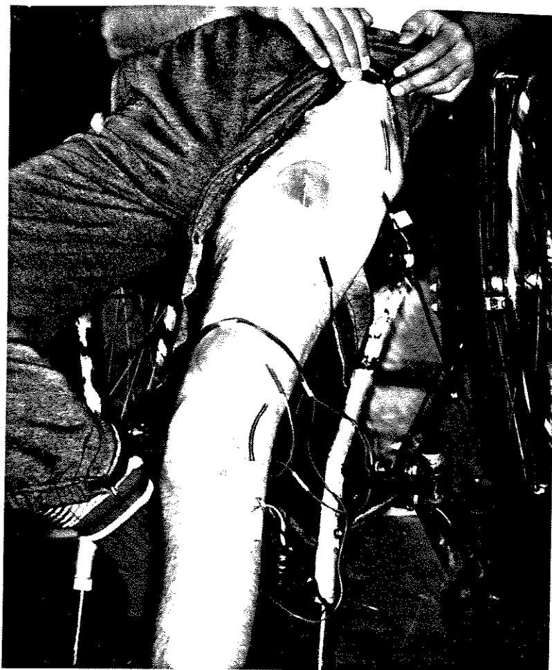
Figura 24 - Localização dos goniômetros de quadril e joelho. Também pode-se ver a localização dos eletrodos femorais.
