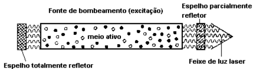
Figura 2.1: Esquema básico de um laser
